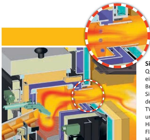
**Sichere Flammenführung.** Ein wichtiges Qualitätskriterium für einen Kombikessel ist eine optimale Flammenführung zwischen den Brennkammern für Pellets und Scheitholz. Sie erhöht die Lebensdauer und Effizienz des Kessels entscheidend. Beim ETA SH-TWIN ist die Öffnung ideal dimensioniert und positioniert. Die Flamme stößt nie auf Hindernisse und kann immer durchzünden. Die Flammenführung erfolgt nur im optimal vor Hitze geschützten Bereich des Kessels.
