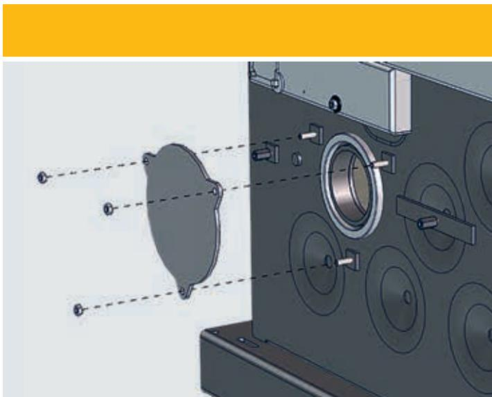
Dieser optionale Zusatz macht die Heizung flexibel. Sollten Sie irgendwann den Vollautomatikkomfort einer Pelletsheizung wünschen, brauchen Sie den ETA TWIN nur anzuschließen – und schon arbeiten die beiden Systeme perfekt zusammen. Der Brenner kann links oder rechts am Scheitholzessel angebracht werden, je nach Raumsituation im Heizungskeller, denn der Flansch ist beidseitig vorhanden.
