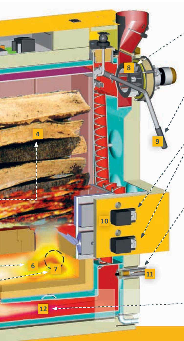
**8 Saugzuggebläse:** Flüsterleise sorgt dieser Ventilator für Unterdruck im Kessel. Zusätzlich regelt er dort die Luftmenge und sorgt damit für Sicherheit im Heizraum.
