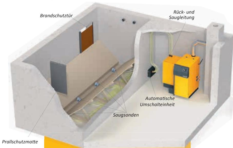
Mit den Saugsonden können nahezu alle Räume für ein Pelletslager genutzt werden, auch wenn sie verwinkelt sind.
