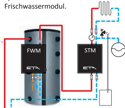
Das Systemtrennmodul sorgt für Sicherheit, wenn Heizsysteme abgetrennt werden sollen: zum Beispiel Stallheizungen, Frostschutzvorrichtungen oder alte Systeme mit Sauerstoffeintrag.
