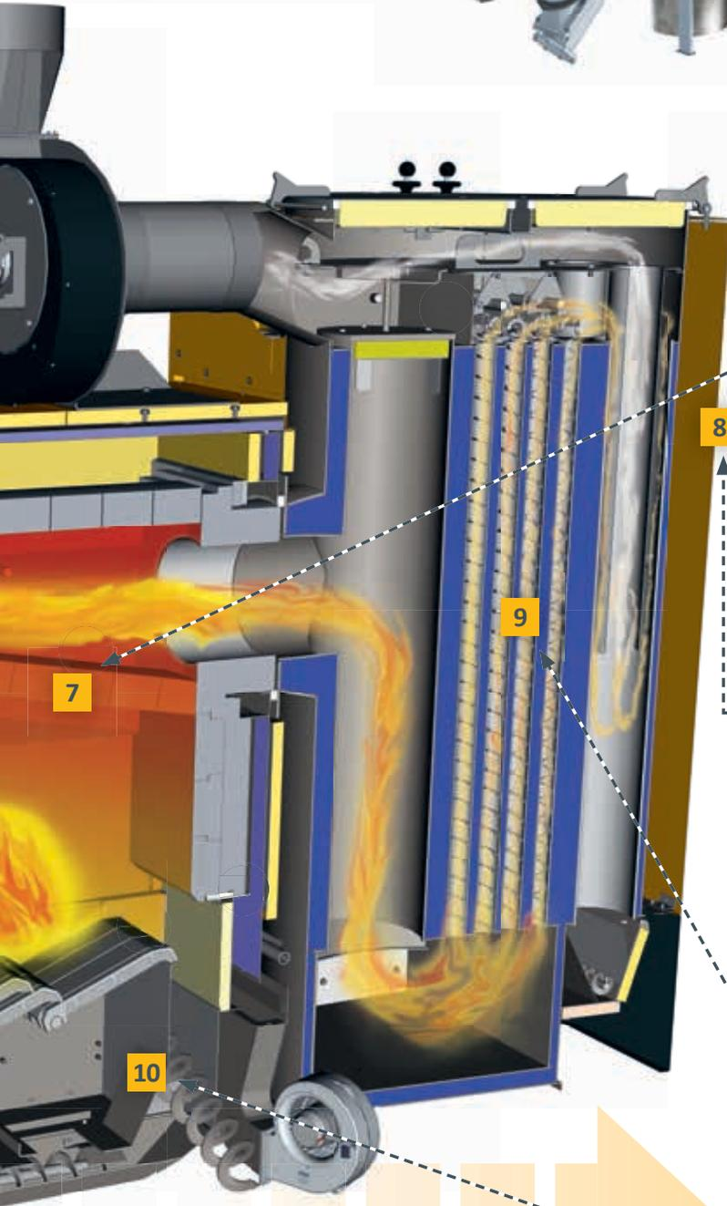
**7 Brennkammer mit Vorschubrost:** Die Brennkammer mit ihrem mehrschaligen, hochtemperaturbeständigen Aufbau ist auf höchste Belastungen ausgerichtet. Das Glutbett wird stetig geschürt. Der seitliche Brennkammerbereich ist durch wassergekühlte Seitenholme extra geschützt. Das sorgt für eine lange Lebensdauer des Kessels. Die Entsachung erfolgt automatisch, wobei ein gemeinsamer Antrieb für Rost und Ascherechen ausreicht.
